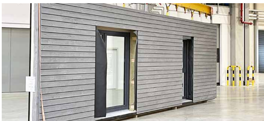
Vorgefertigtes Fassadenelement (auf der Baustelle direkt zu montieren)
